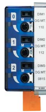
PCD3.W800 4 Wyjścia analogowe (3 sterowane ręcznie)
